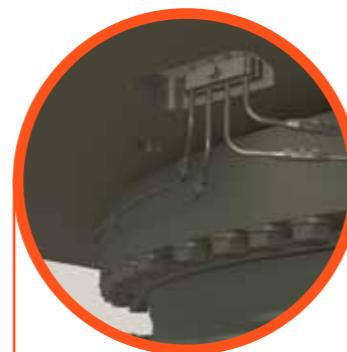
**Надежность** В EX1200-7 используется кованый пьедестал поворотного подшипника, который пришел на замену литому элементу, а также увеличенная толщина верхней плиты (до 55 мм), что позволило увеличить прочность и долговечность рамы.
