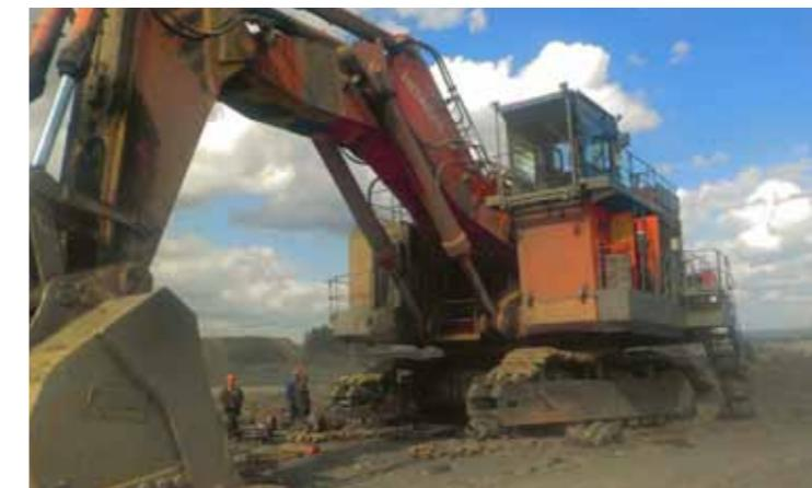
2007 года и был выведен из эксплуатации в 2019 году. За время работы продемонстрировал высокую производительность и надежность, показал рекордную наработку моточасов и объемы поднятой горной массы. В среднем он вырабатывал 410–430 тыс. м<sup>3</sup> в месяц. За все годы эксплуатации на экскаваторе проводились только плановые ремонты согласно графику – ремонт и замена гидроцилиндров, насосов и редукторов, замена узлов (РПН, ДВС, редуктора и т. д.).
