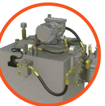
**Производительность** EX1200-7 в конфигурации «обратная лопата» дополнительно оснащается автоматической системой смазки пальцев ковша (в дополнении к остальным точкам рабочего оборудования и поворотной платформы).
